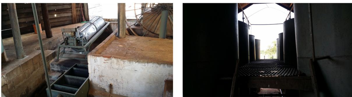
**Figura 3:** Peneira e decantador (esquerda) e dornas de fermentação (direita)
