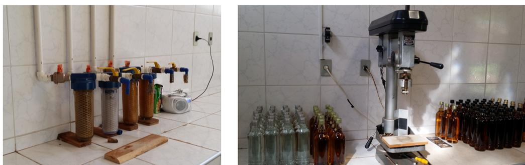
**Figura 7:** Equipamentos de envase (esquerda) e lacração (direita)
