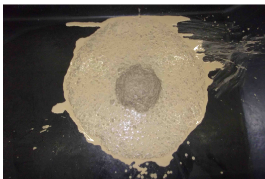
Figura 3: CAA com espalhamento inadequado
