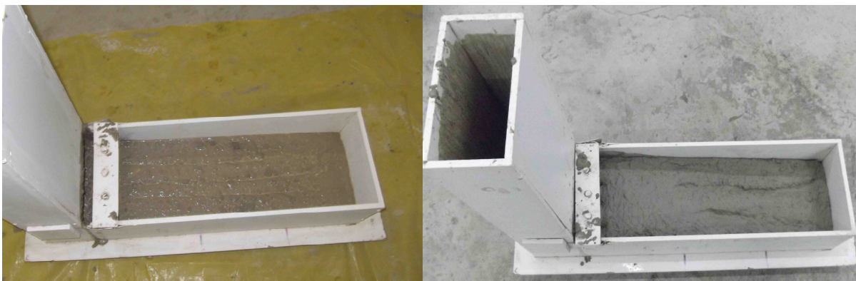
Figura 6: Ensaios na caixa L - a) CAA sem resíduo; b) CAA com adição de resíduo
