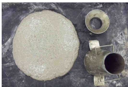
Figura 4: Ensaio adequado do CAA
