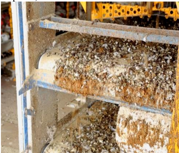
Figura 5: Transportador de cinta automatizado de dejetos (detalhe do raspador)
