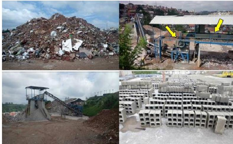
**Figura 8.** Áreas e equipamentos envolvidos no processo de reciclagem do RCC - Usina 5. Fonte: Dados da pesquisa
