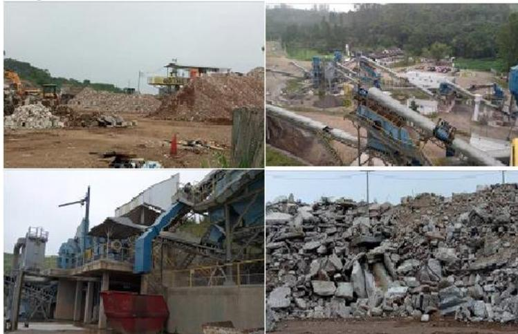
**Figura 6.** Áreas e equipamentos envolvidos no processo de reciclagem do RCC - Usina 3. Fonte: Dados da pesquisa.
