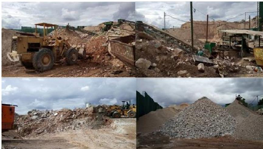
**Figura 7.** Áreas e equipamentos envolvidos no processo de reciclagem do RCC - Usina 4. Fonte: Dados da pesquisa
