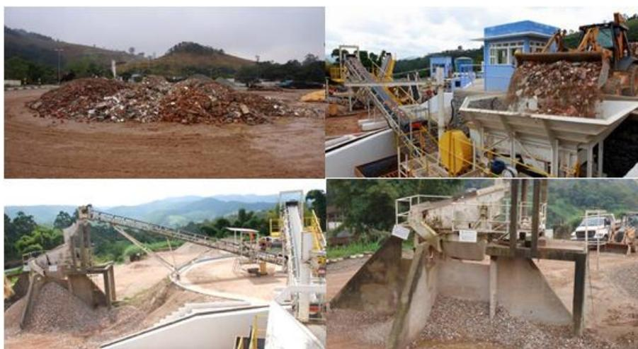
**Figura 4.** Áreas e equipamentos envolvidos no processo de reciclagem do RCC - Usina 1. Fonte: Dados da pesquisa
