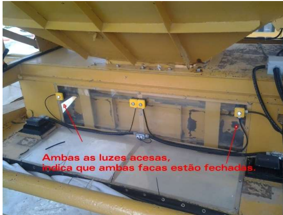
Figuras 6 e 7: luzes indicativas colocadas no interior da moega, vistas pelas câmeras
