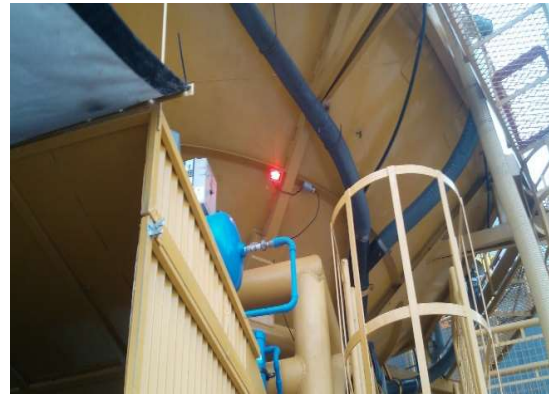
Figuras 8 e 9: Luzes externas verde e vermelha para indicar moega aberta ou fechada
