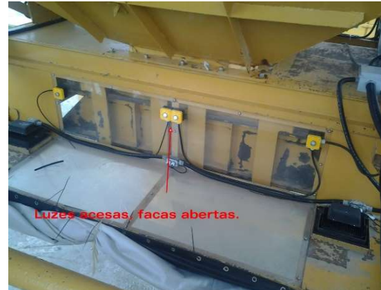
Figuras 6 e 7: luzes indicativas colocadas no interior da moega, vistas pelas câmeras
