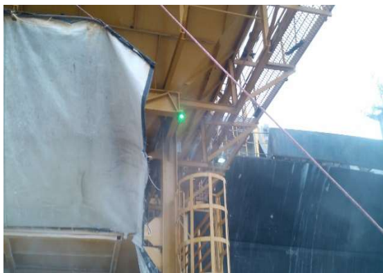
Figuras 8 e 9: Luzes externas verde e vermelha para indicar moega aberta ou fechada
