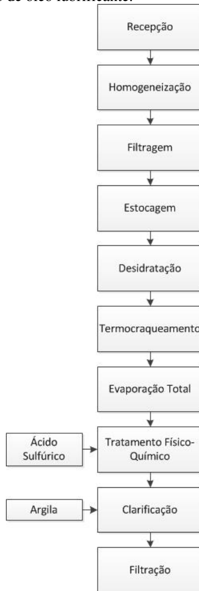
Figura 5. Processo de rerrefino de óleo lubrificante.
