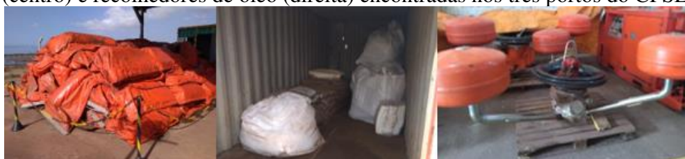
Figura 1 – Fotografias das barreiras de contenção (esquerda), barreiras/mantas absorventes (centro) e recolhedores de óleo (direita) encontradas nos três portos do CPSL.
