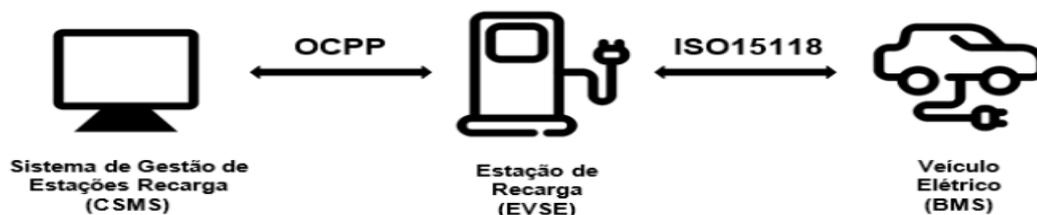
**Figura 2.** Protocolos de recarga de veículos elétricos.
