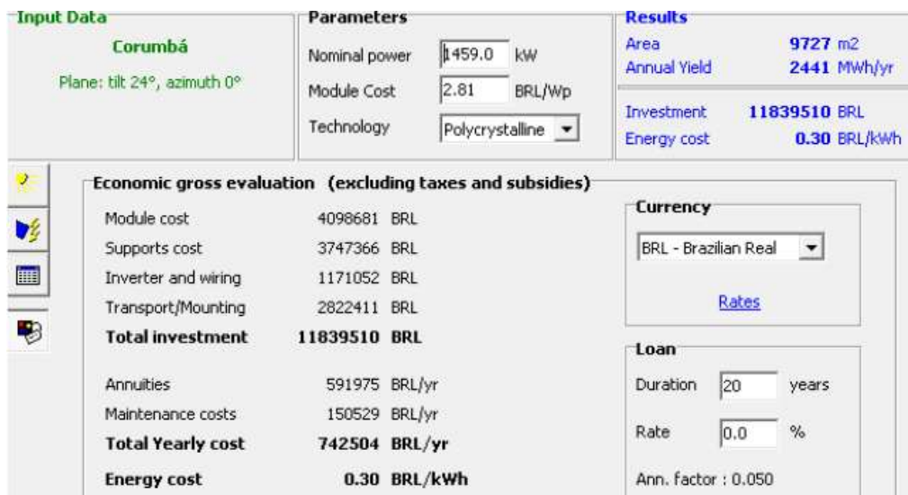
Figura 06 – informações monetárias sobre a usina solar
