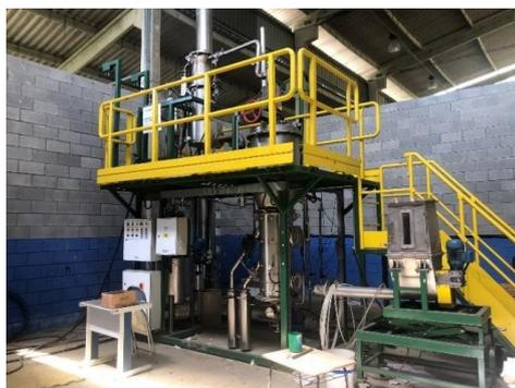
**Figura 11.** Equipamento incinerador. Fonte: Dados da Pesquisa.
