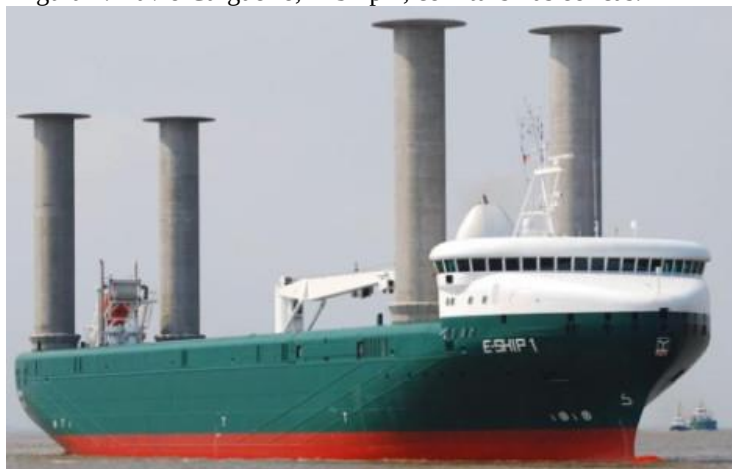
Figura 1. Navio Cargueiro, E-Ship 1, com turbinas eólicas.
