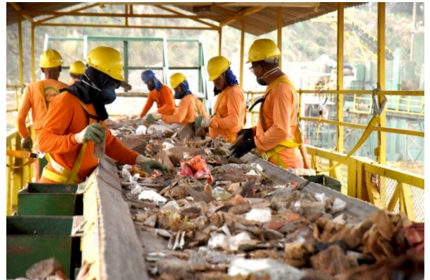
Fig.01 -Geresol faz triagem de resíduos de construção civil e de outros materiais reaproveitáveis.
