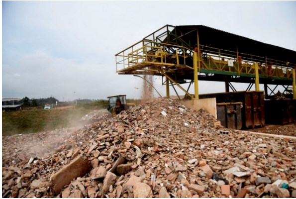
Fig.01 -Geresol faz triagem de resíduos de construção civil e de outros materiais reaproveitáveis.
