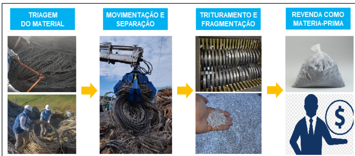
Figura 3 - Fluxo Geral Trituração de Cabos
