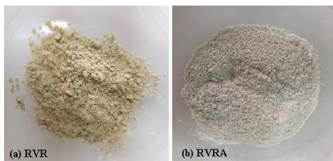
Figura 2 - Rejeito de vermiculita antes e após ativação ácida. (a) RVR e (b) RVRA.
